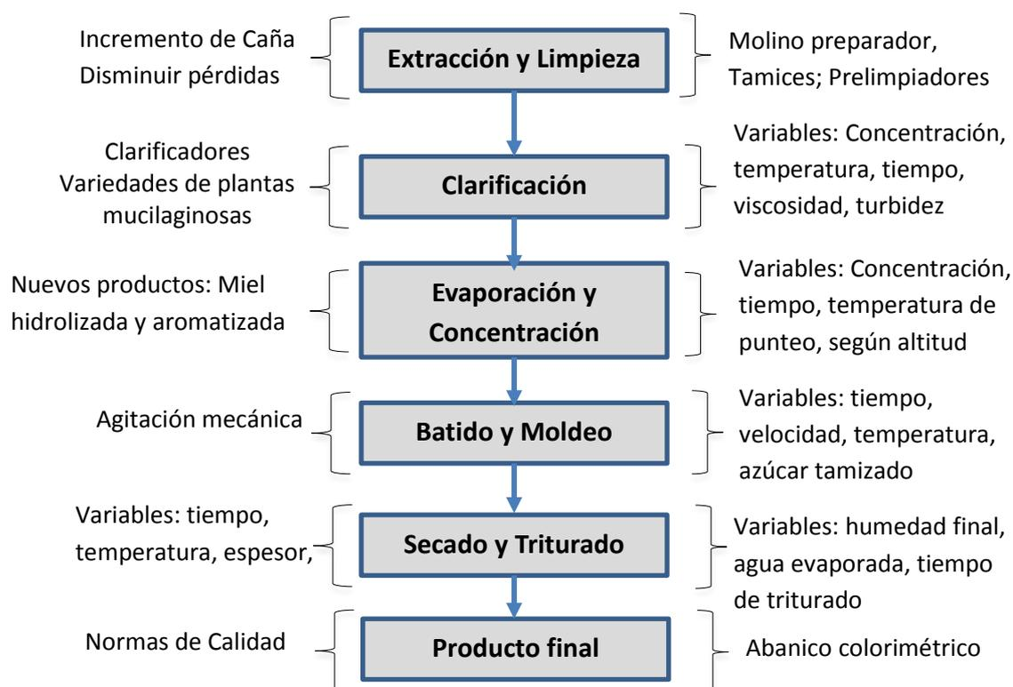
Figura 2.6 Esquema de las propuestas de intensificación en la producción de panela.
