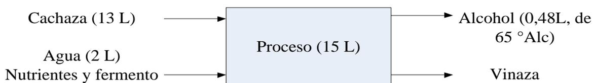
Figura 3.5. Esquema de obtención de alcohol a partir de cachaza.
