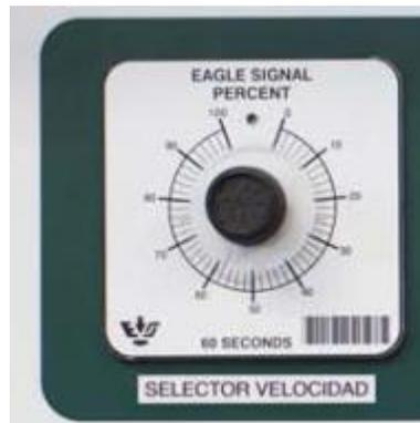
Figura 2.1. Selector de velocidad en el panel de la máquina de riego
