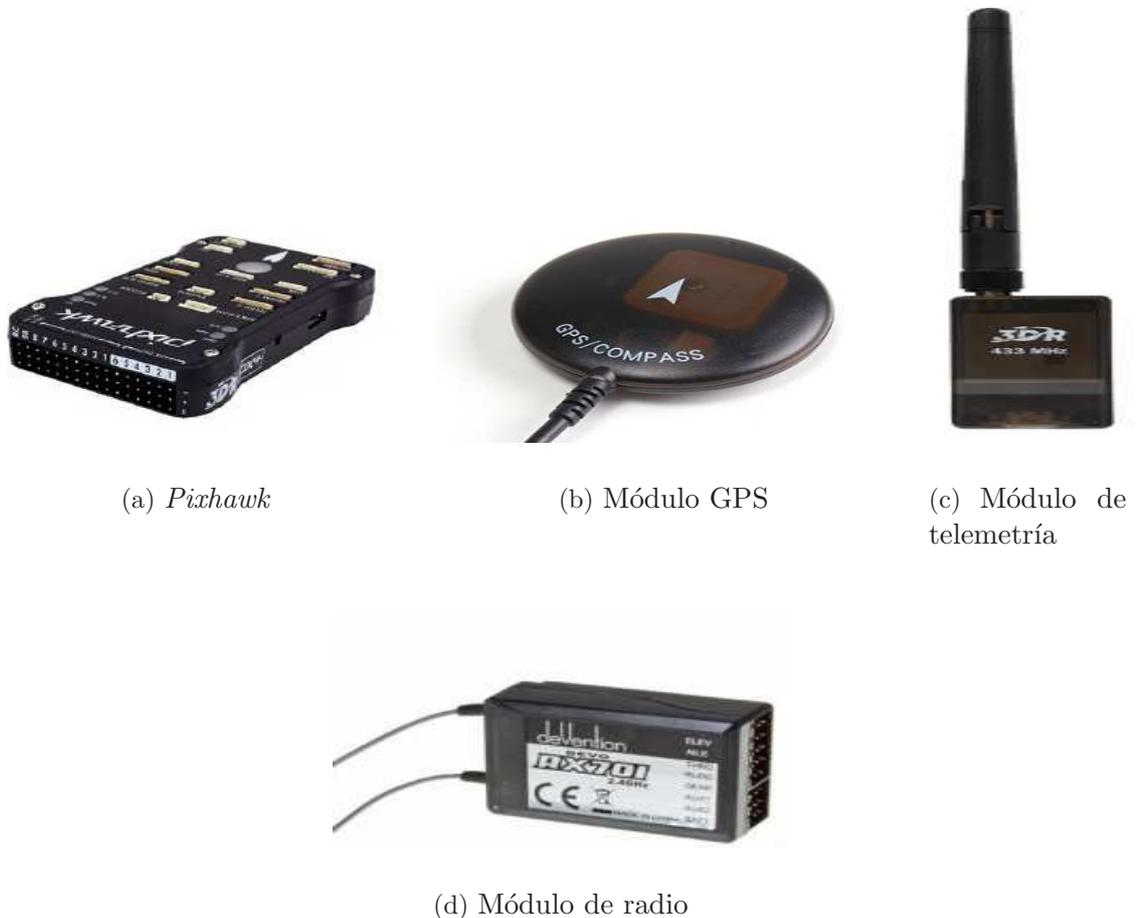
Figura 1-5: Componentes electrónicos
