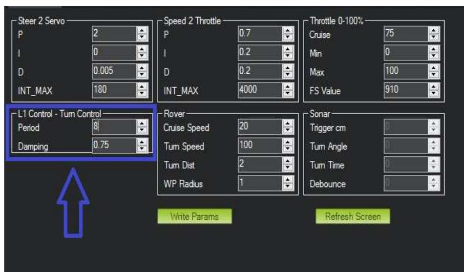
Figura 4-5: Parámetros de configuración del algoritmo de guiado NLGL
