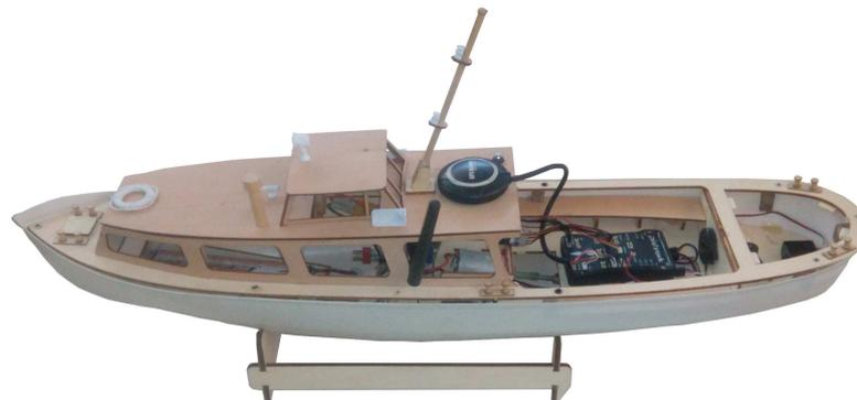
Figura 1-7: Elementos de hardware instalados en el *Krick Felix*
