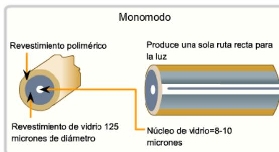
Figura 2. Fibra óptica monomodo.
