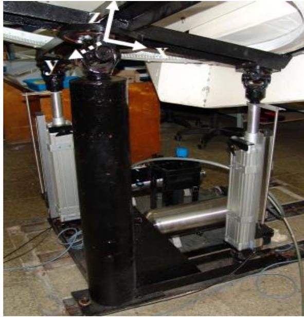
Figura 2.1 Estructura mecánica y el sistema electro-neumático del simulador de conducción.
