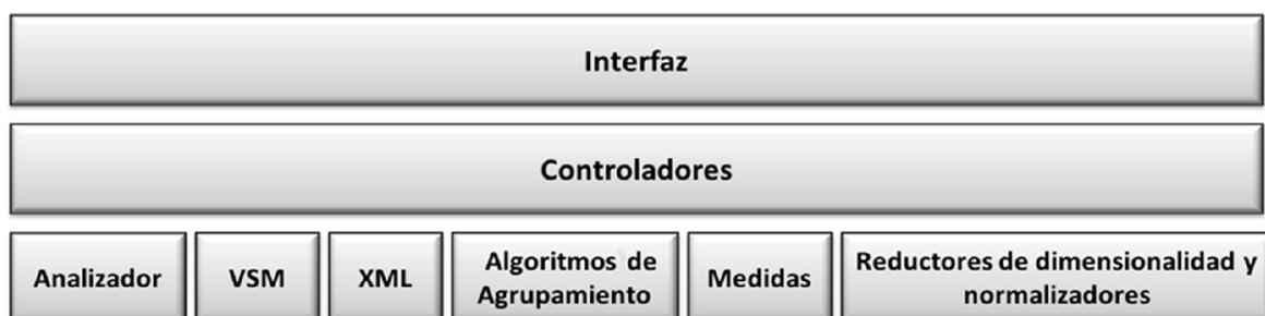
Figura 2.6 Diseño general del sistema *XMLearning*
