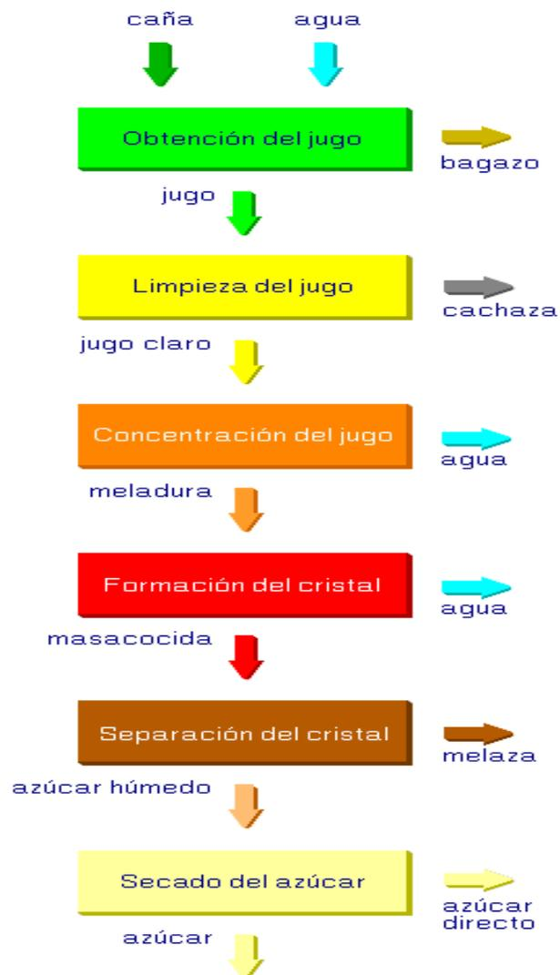
Figura 22: Diagrama de bloque del proceso de producción de azúcar crudo.
