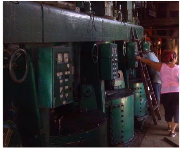
**Figura 2.8 Centrifugas de 1ra**
