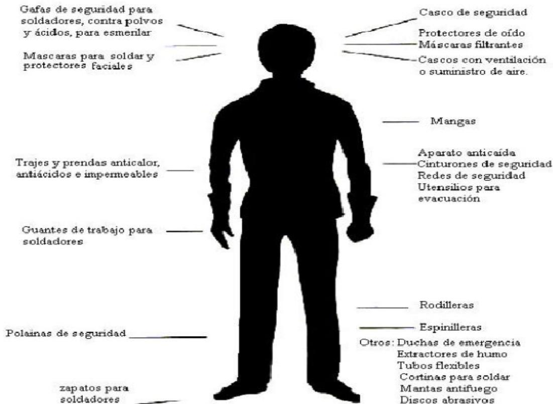
Fig. 3.9. Prendas protectoras necesarias para la seguridad del soldador.
