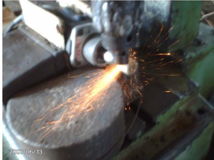
Figura 3.4: Foto del proceso de desbaste empleando la muela abrasiva del punto 3, grano No. 54.
