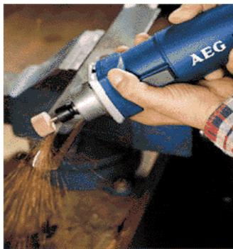
*Figura 1.3.: Muela abrasiva sobre vástago en operación de desbaste.*
