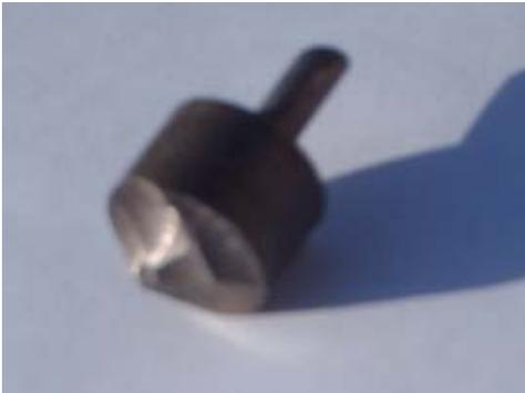
*figura 3.1: Probeta de acero AISI-1015*
