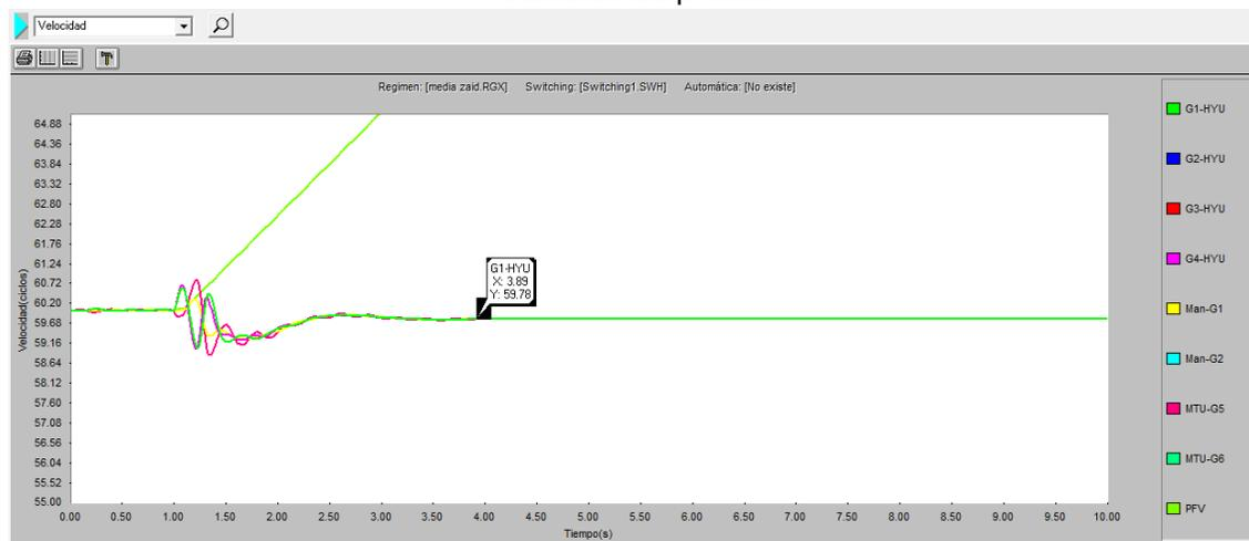
Figura 10 Respuesta de frecuencia ante un cortocircuito monofásico en la barra Camara5-Carp-Trns.
