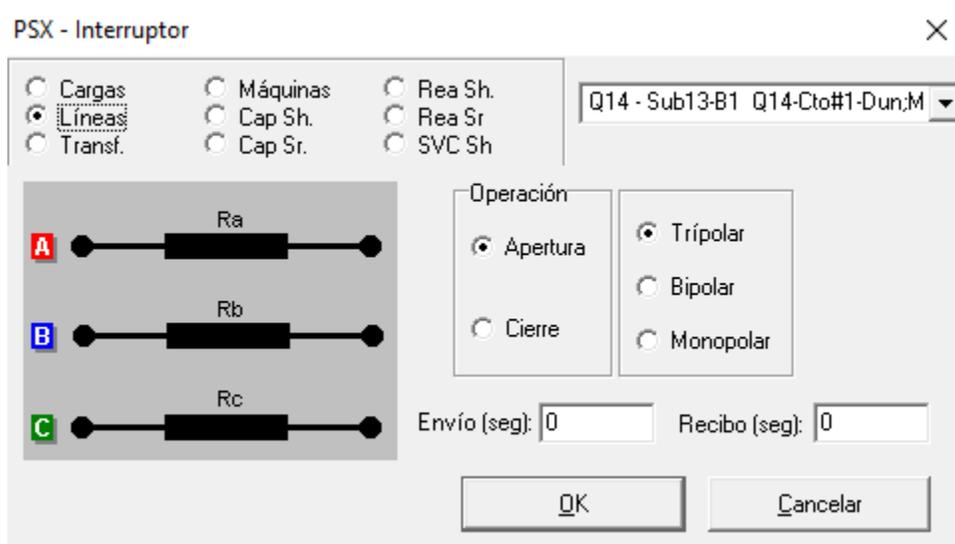
Figura 2.7 Interfaz del PSX para la programación de apertura y cierre de un interruptor.
