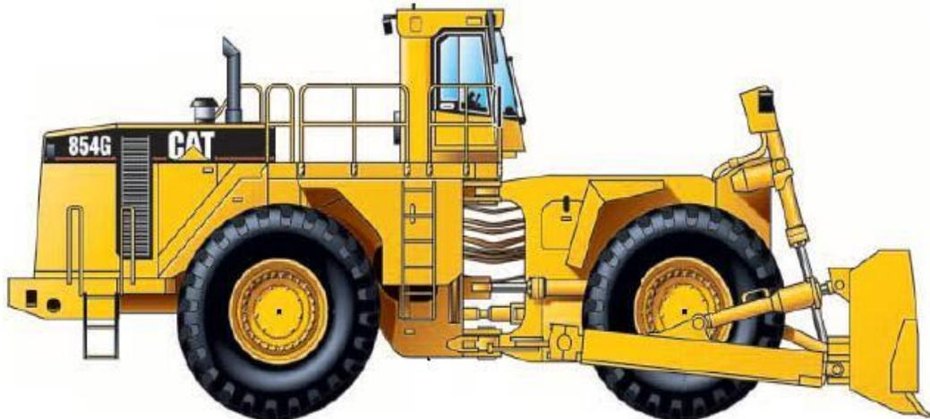
Figura 1.2. Equipo destinado al corte, desmonte y nivelación del terreno montado sobre neumáticos. “Maquinaria y Equipo de Construcción” (Ayllon, 2017).
