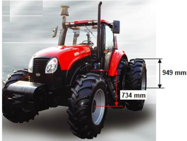
Figura 3.3 Radios de las ruedas traseras y delanteras del tractor YTO 1604.
