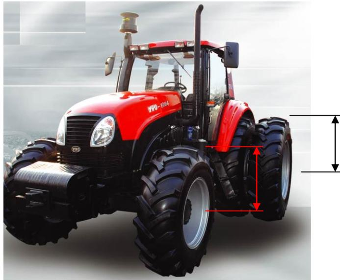
Figura 2.4. Determinación de los radios de las ruedas delanteras y traseras del tractor.
