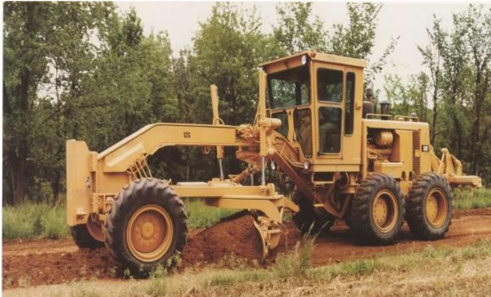
Figura 1.12. Motoniveladora. “Maquinaria y Equipo de Construcción” (Ayllon, 2017).
