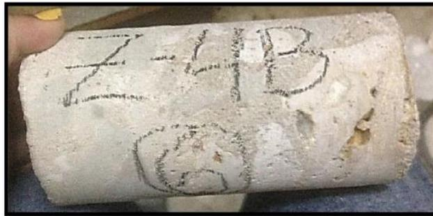
**Fig. III.9** Presencia de áridos calizos de gran tamaño en una probeta testigo de hormigón.
