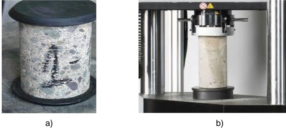
Fig. II.16 a) Probeta testigo de hormigón. b) Ensayo a compresión de la probeta. Con la realización de este ensayo se puede realizar el control de la calidad del hormigón y un control estadístico del mismo. A continuación en la Figura II.17 se muestran imágenes de estos aspectos.
