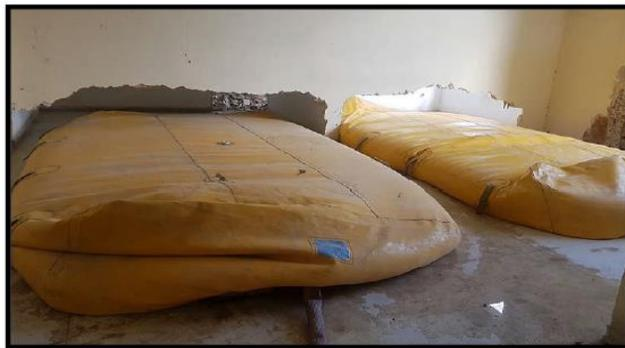
**Fig. III.16** Bolsas de agua, utilizadas en la aplicación de las pruebas de carga.
