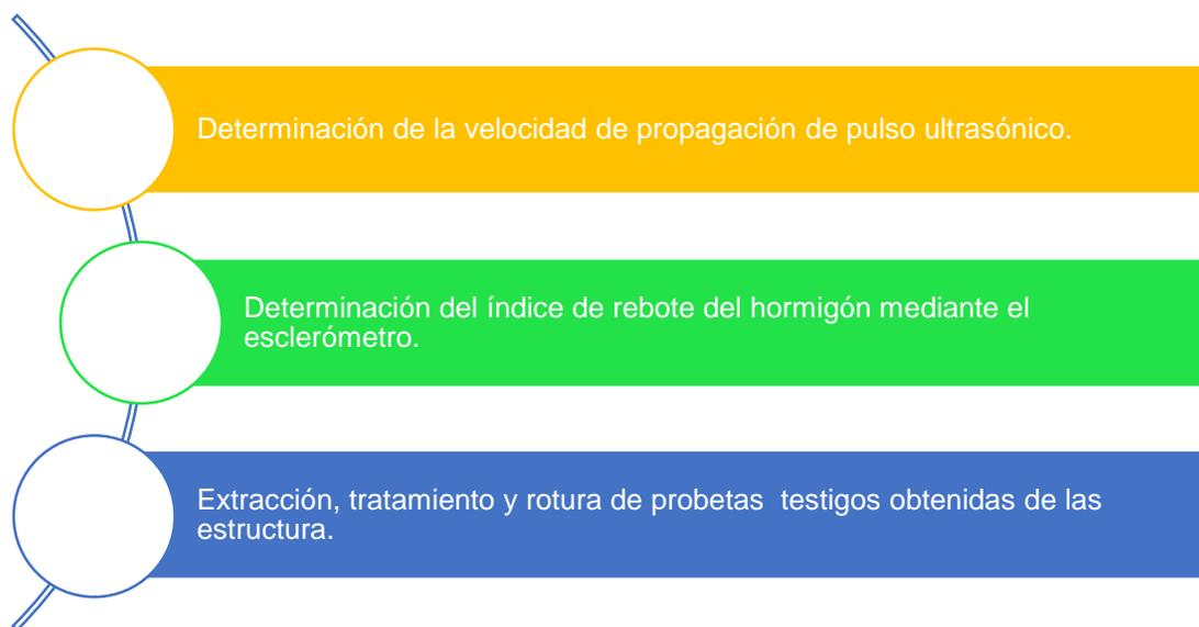
**Fig. II.12** Ensayos realizados para estimar la resistencia a compresión del hormigón. (NC-1109:2015, 2015)
