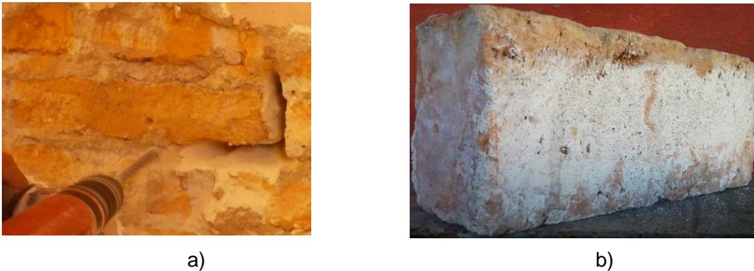
**Fig. II.18** a) Extracción de testigos de ladrillos b) Muestra de uno de ladrillo (Fuentes Figueroa, 2019)
