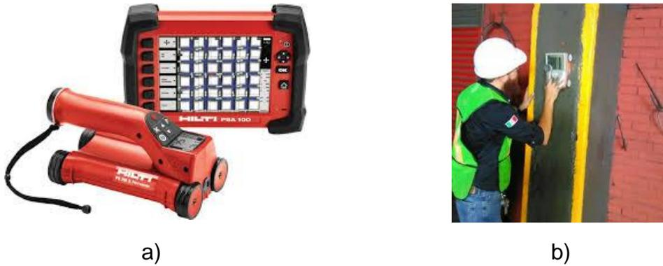
**Fig. II.7** Ferroskan para la determinación de acero: a) Ferroskan200 b) Empleo del mismo
