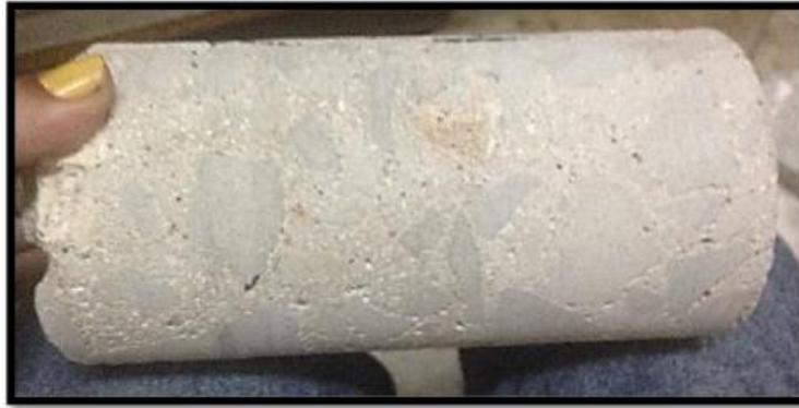
**Fig. III.8** Presencia de Árido de granulometría discontinua en una probeta testigo de hormigón.
