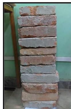
**Fig. III.15** Muestras de los ladrillos macizos, extraídos en la edificación.
