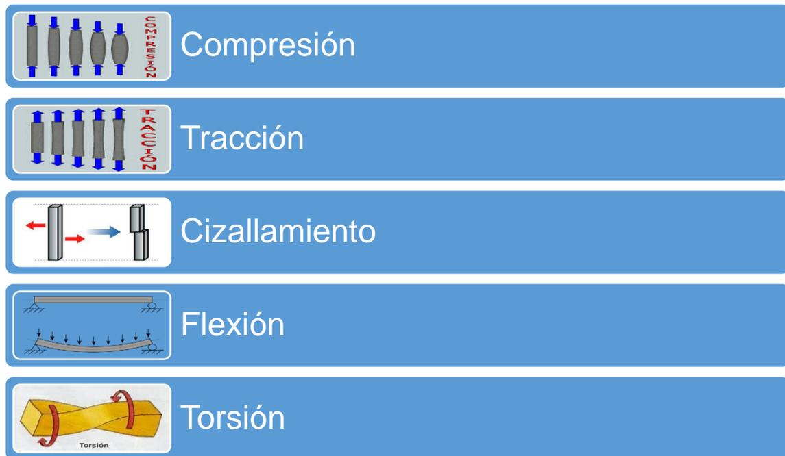
Fig. II.6 Deformaciones estudiadas en Resistencia de Materiales.(Chagoyén Méndez, 2018a)
