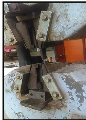
**Fig. III.14** Ensayo a compresión de una de las muestras de los elementos metálicos.
