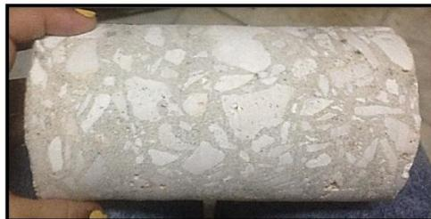
**Fig. III.10** Probeta testigo de hormigón con presencia de partículas planas y alargadas.
