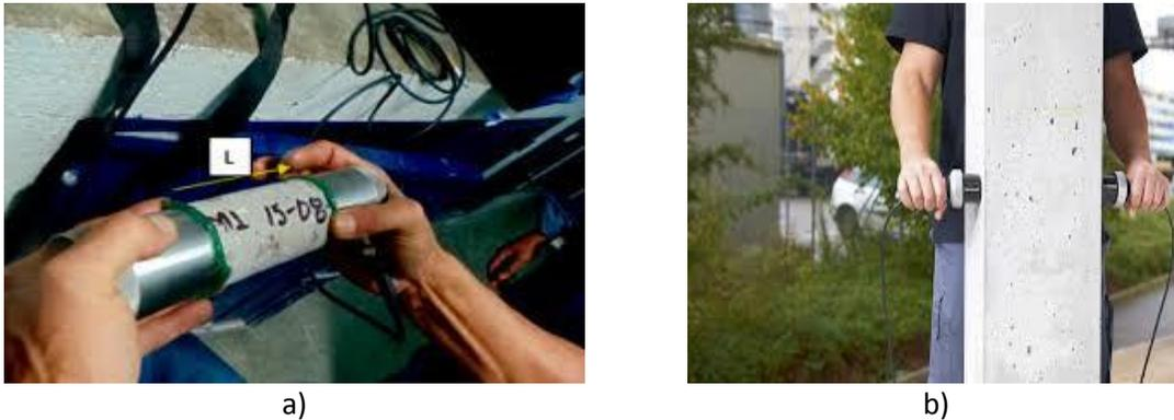
**Fig. II.13** Determinación de la resistencia del hormigón con el pulso ultrasónico: a) Equipo utilizado para la determinación del pulso ultrasónico., b) Realización del ensayo.
