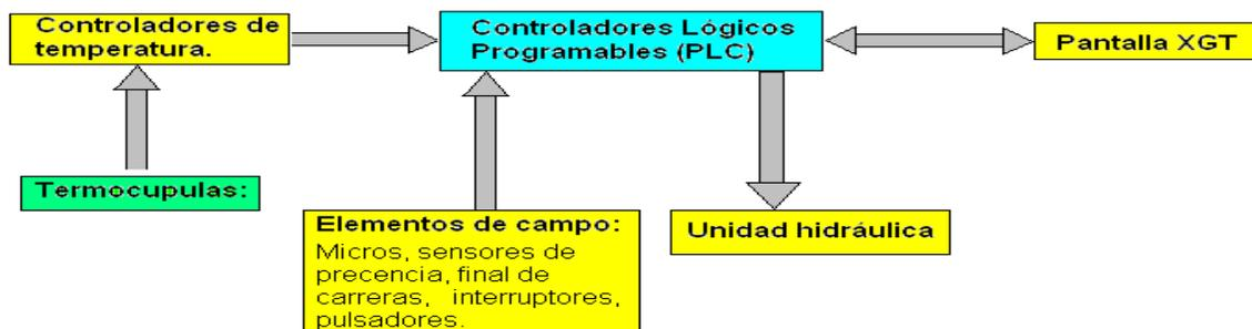
Fig-2.1 Sistema de control de la máquina.
