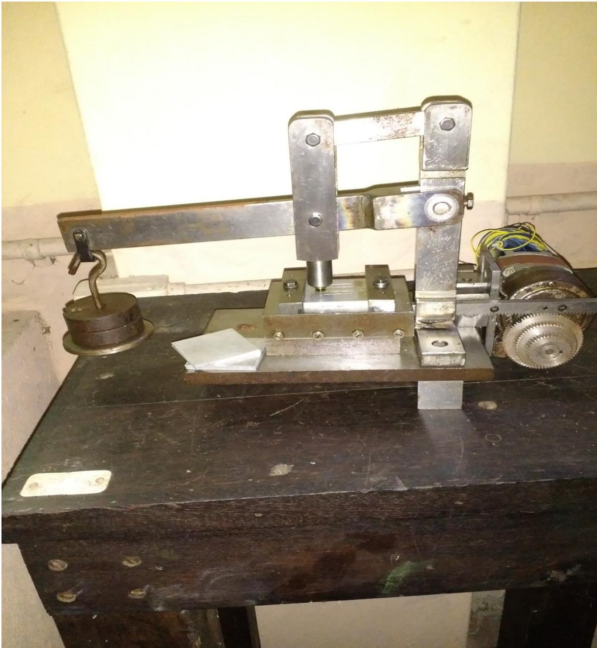
**Figura 1.5-** Máquina para realizar el ensayo de rayado existente en la Facultad de Ingeniería Mecánica e Industrial.
