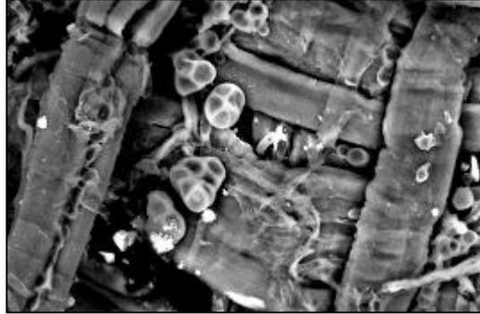
Figura 15. Análisis mediante Microscopía electrónica (SEM) de un fragmento de un libro biodeteriorado. Se observan las fibras de papel y los conidios fúngicos. Tomado de Pinzari y colaboradores, 2010.
