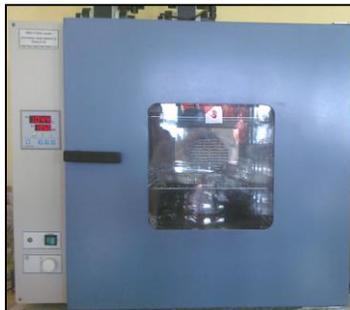
Figura 7. Muestras de papel en placas de Petri en el horno durante el envejecimiento.
