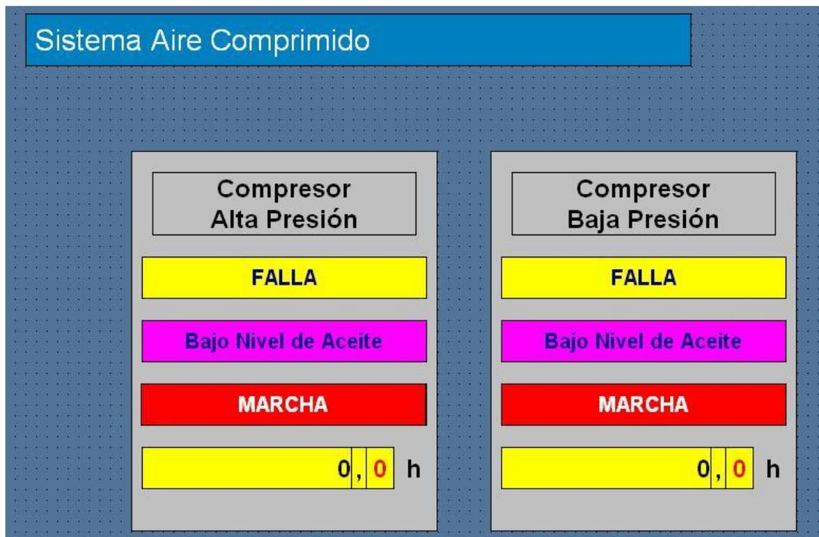
Figura 2.3: Mímico del sistema de compresores
