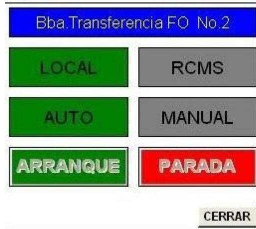
Figura 2.19: Bloqueo de operación de arranque y parada remota de bombas de transferencia desde el SCADA, si no está activada la señal de RCMS.
