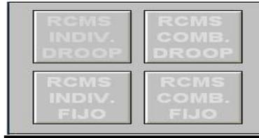
1. Carga base individual (RCMS INDIV FIJO): La carga en % y el Factor de Potencia (FP) se fija por el software desde el SCADA en la ventana de Control kW y PF.
