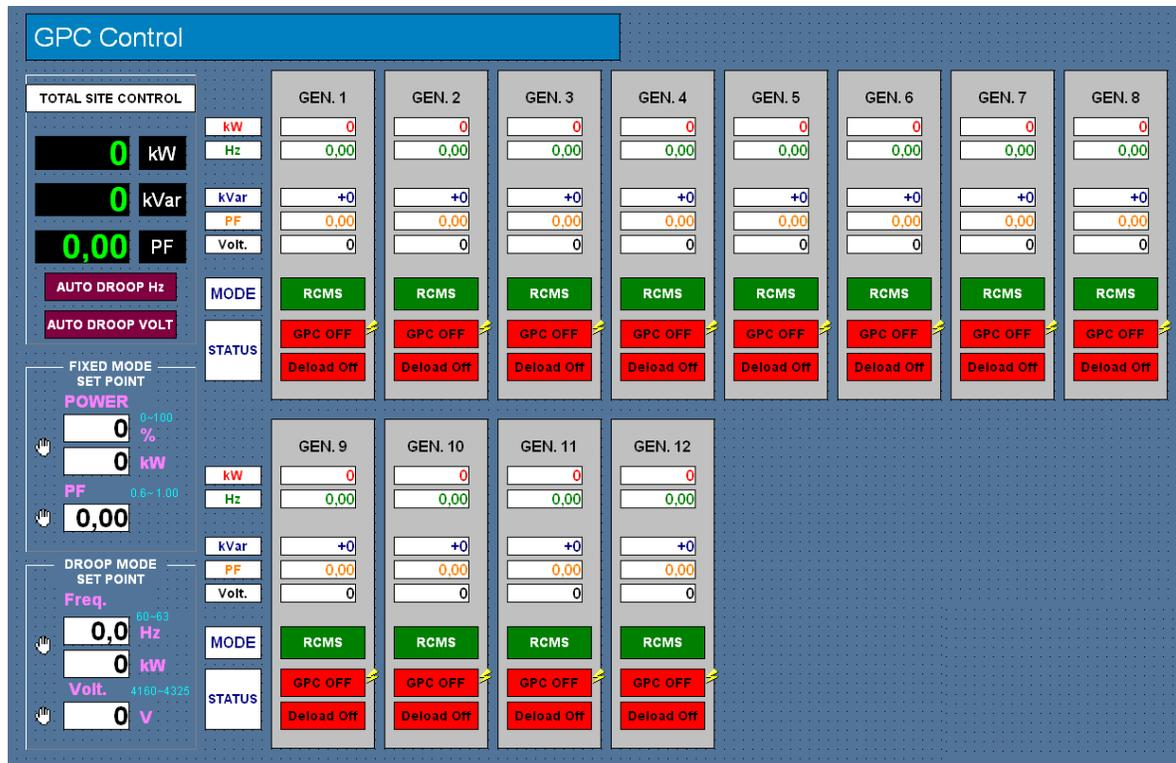
Figura 2.6: Mímico **GPCCtrl.PDL**, proyecto típico Hyundai 12 motores.
