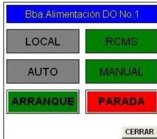
Figura 2.20: Operación de arranque y parada remota de bombas de alimentación desde el SCADA habilitada, con la señal de RCMS activada.
