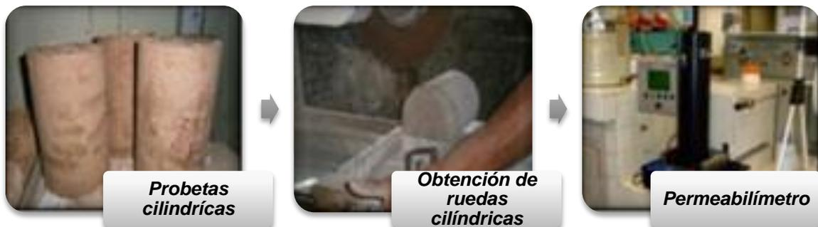
Figura 2.8: Ensayo de permeabilidad al agua.
