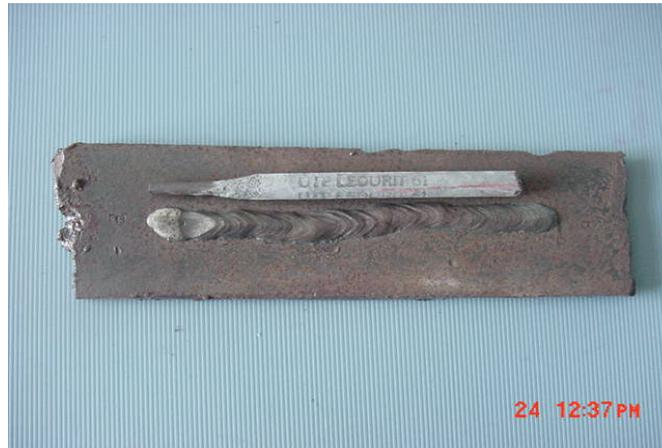
Figura 19. Depósito terminado y colilla del aporte (proceso por arco) [23].
