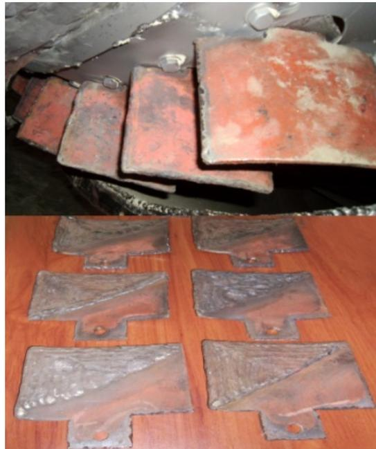
Figura 28. Álabes que conforman el exhaustor.
