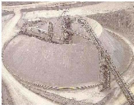
Figura 4. Proceso de homogenizado
