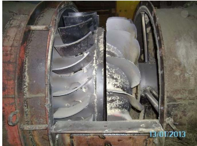
Figura 7. Exhautor de la Fábrica de Cemento Siguaney.
