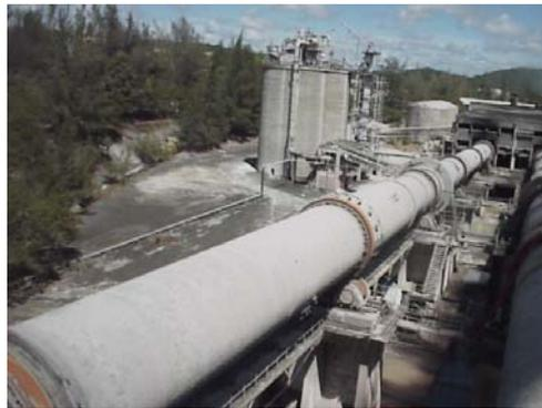
Figura 5. Horno rotatorio de secado
