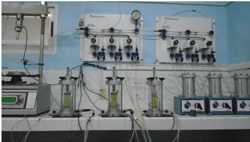
Figura 2.9 Cámara Triaxial del IPH VC
