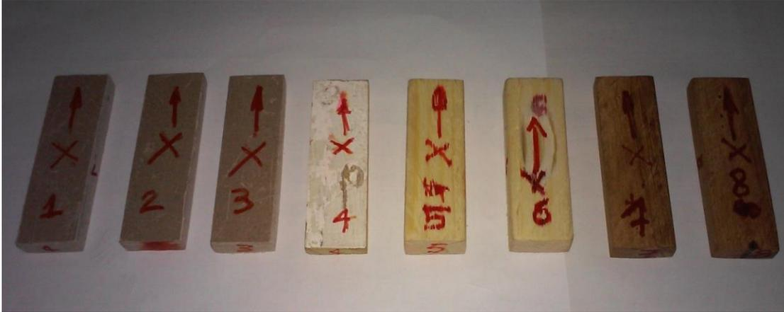
Figura 16. Probetas de los diferentes materiales enumeradas y señalado su sentido de ubicación en el portaprobetas.
