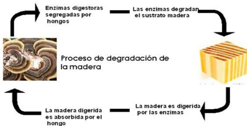
Figura 3. Proceso de degradación de la madera.
