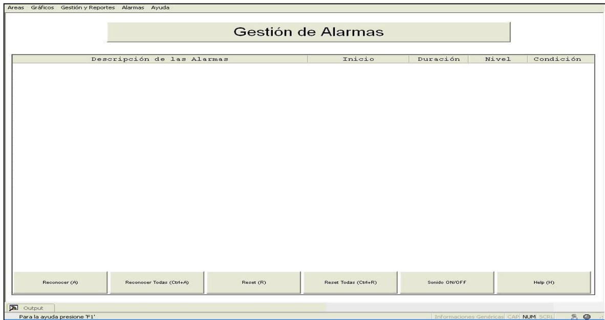
**Figura 2. 18: Pantalla de visualización de alarmas.**
