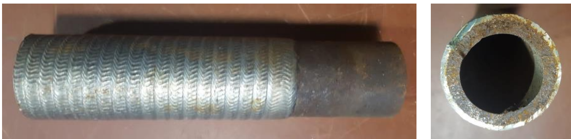
Figura 14 Tubo de sobrecalentador de vapor con recubrimiento de ICONEL 625.
