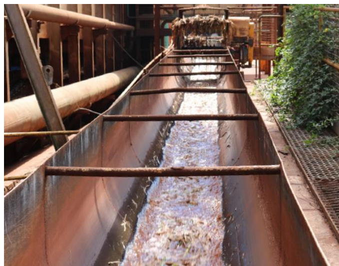
Figura 18 Sistema industrial de lavado de paja con agua y transporte Fuente: Proyecto SUCRE, 2019)
