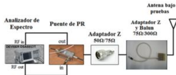
Figura. 10: Esquema de dispositivos para la medición de pérdidas por retorno
