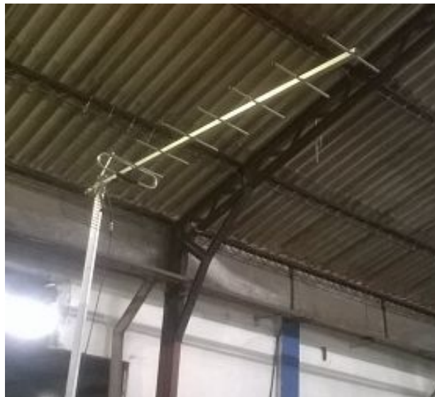
Figura. 9: Prototipo Antena Uda-Yagi de 9 elementos con reflector esquinado
