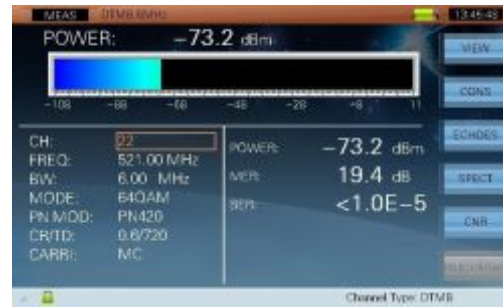
Figura. 3: Primera medición realizada con un dipolo de λ/2 PROMAX AM-030 sobre el canal 22 de Caibarién
