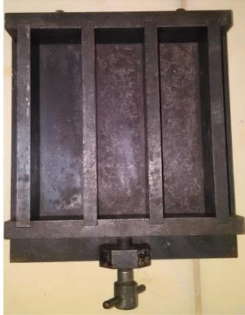
**Figura 2.19** Molde empleado para la elaboración de los morteros.
