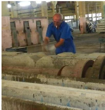
**Figura 2.27 Obrero eliminando el excedente de hormigón entre los durmientes.**
