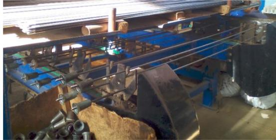
**Figura 2.6 Aceros situados correctamente para su posterior colocación en el molde.**
