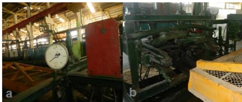
Figura 2.23 a. Manómetro. b. Gato que transfiere la tensión al grupo de alambres. Fuente: EIFF.
