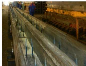
**Figura 2.18 Molde luego del proceso de limpieza y engrase.** Fuente: Elaboración propia.
