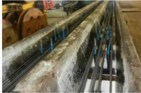
**Figura 2.20 Colocación de los grupos de alambres en el molde.** Fuente: Elaboración propia.
