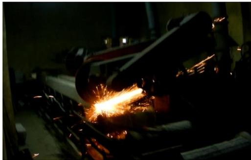
**Figura 2.28 Separación de los durmientes mediante sierra de corte.** Fuente: Elaboración propia.
