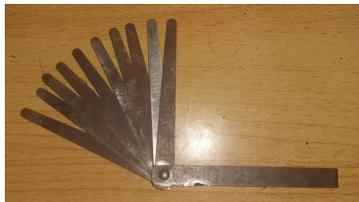
**Figura 2.31 Galga de espesores utilizada en las mediciones.** Fuente: Elaboración propia.
