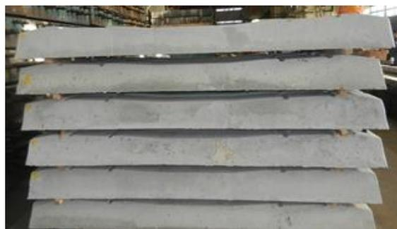
**Figura 2.17 Durmientes separados mediante maderos rectangulares.** Fuente: Elaboración propia.
