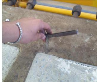
**Figura 2.32 Medición con galga de espesores en el molde.** Fuente: Elaboración propia.
