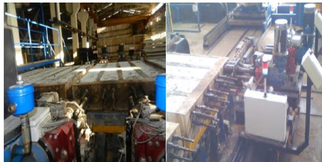
**Figura 2.13 Máquina de destese.** Fuente: Elaboración propia.
