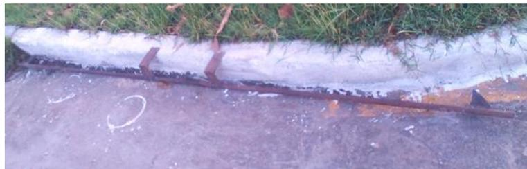
**Figura 2.34 Dispositivo de distancia fija para medir los acortamientos diferidos.**
