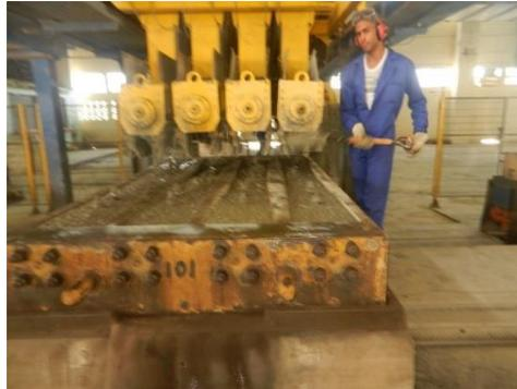
Figura 2.10 Vertido y nivelación de la mezcla en el molde. Fuente: Elaboración propia.
