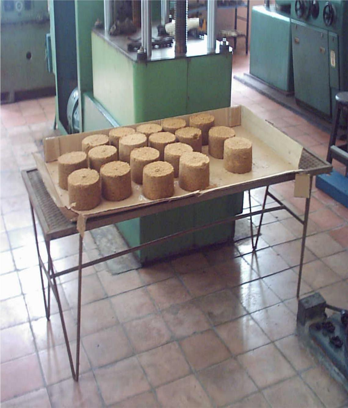
**Anexo 8.** Briquetas después de prensadas con un 10% de arcilla
