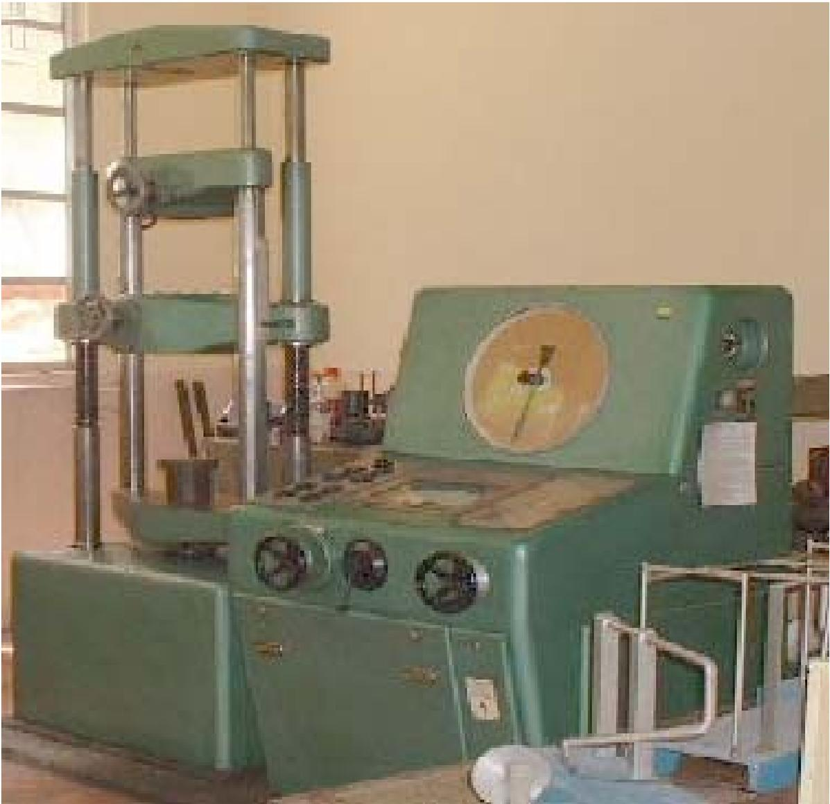
**Anexo 2.** Prensa utilizada para elaborar los BSC. Máquina Universal de Ensayos ZD-40
