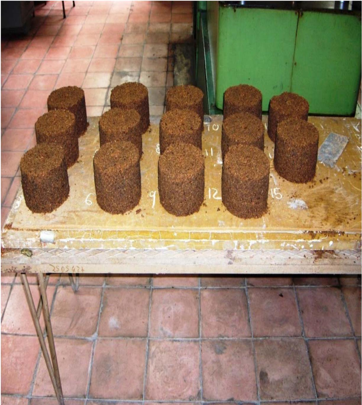
**Anexo 7.** Briquetas después de prensadas con un 20% de arcilla.
