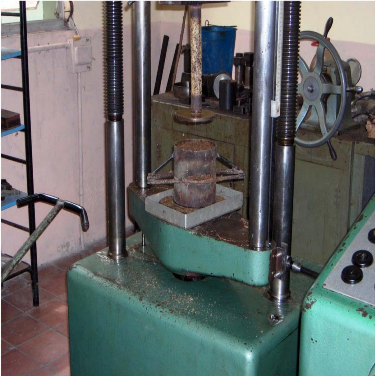
**Anexo 3.** Prensa con el dispositivo listo para fabricar las briquetas
