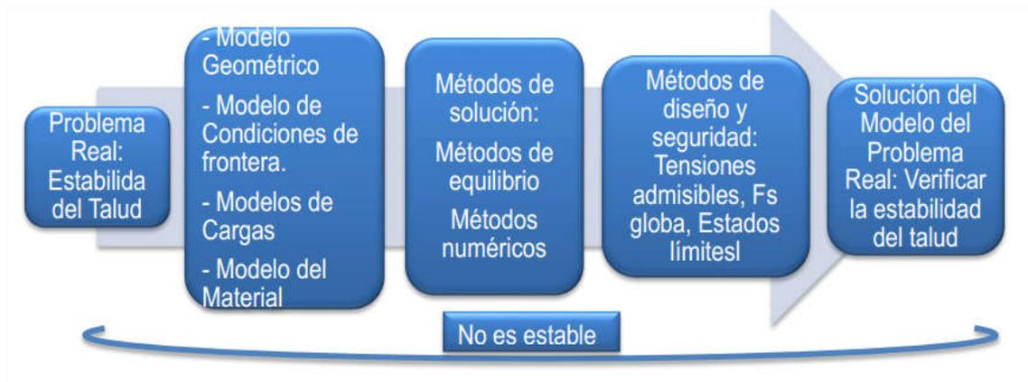
**Figura 3.2. Diagrama base para la realización de una modelación (Fuente: Hernández, 2014).**
