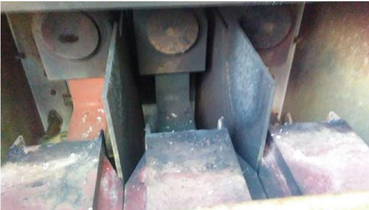
Figura II.4.1: Transformador de Corriente luego de la falla.
