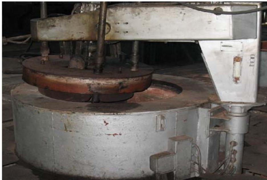
**Figura 22. Horno de revenido para piezas pequeñas (Planta Mecánica)**
