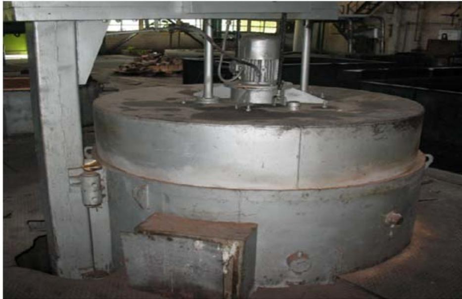
**Figura 21. Horno de temple para piezas pequeñas (Planta Mecánica)**
