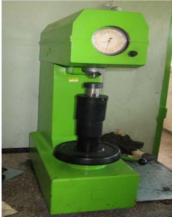
**Figura 25. Durómetro Rockwell (Planta Mecánica)**
