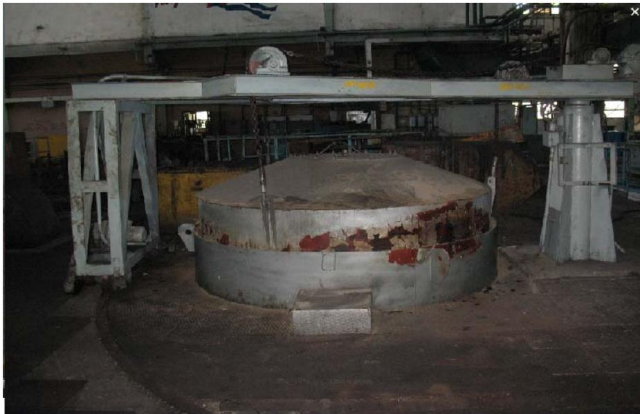
**Figura 20. Horno de revenido para piezas de grandes dimensiones (Planta Mecánica)**
