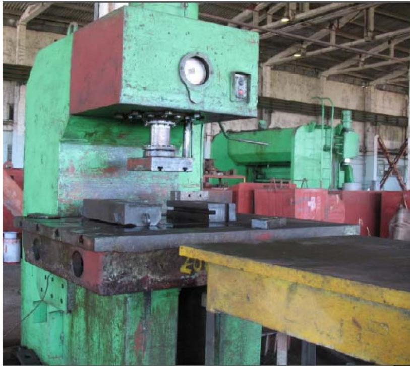
**Figura 26. Prensa para enderezado de piezas (Planta Mecánica)**
