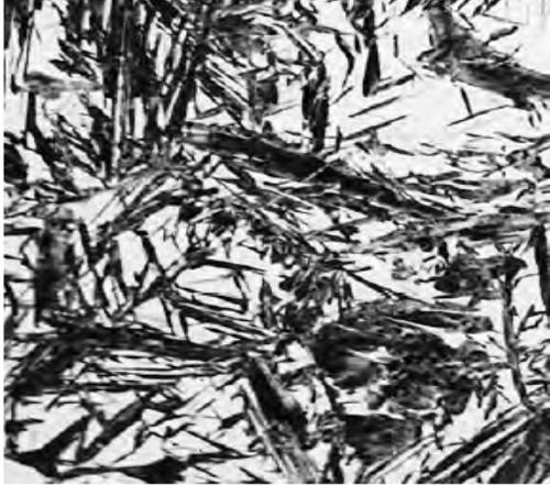
**Figura 2. Fotomicrografía a 1220X que muestra la microestructura de la martensita. Los granos en forma de aguja son los de martensita y las regiones blancas son austenita que no transformaron durante el tratamiento [1]**
