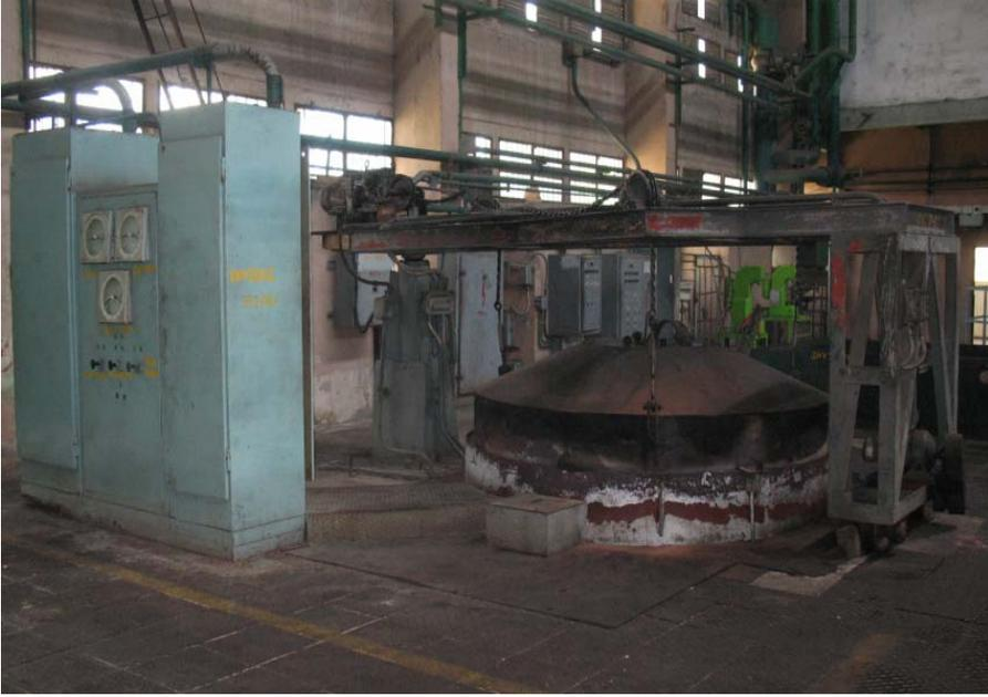
**Figura 19. Horno de temple para piezas de grandes dimensiones (Planta Mecánica)**
