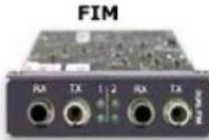
La función básica de esta tarjeta es convertir la señal óptica recibida sobre el cable de fibra a una señal eléctrica y viceversa. Permite la conexión de NSU y de gabinetes periféricos al Controlador 3300 Mxe.
