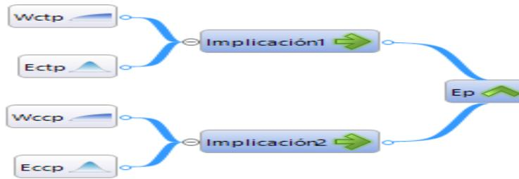
Figura 3. 6 Árbol difuso para determinar el valor de verdad del indicador de evaluación del proceso (Ep)
