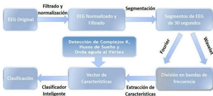
Figura 2. Diagrama descriptivo del proceso realizado en la detección de fases del sueño.
