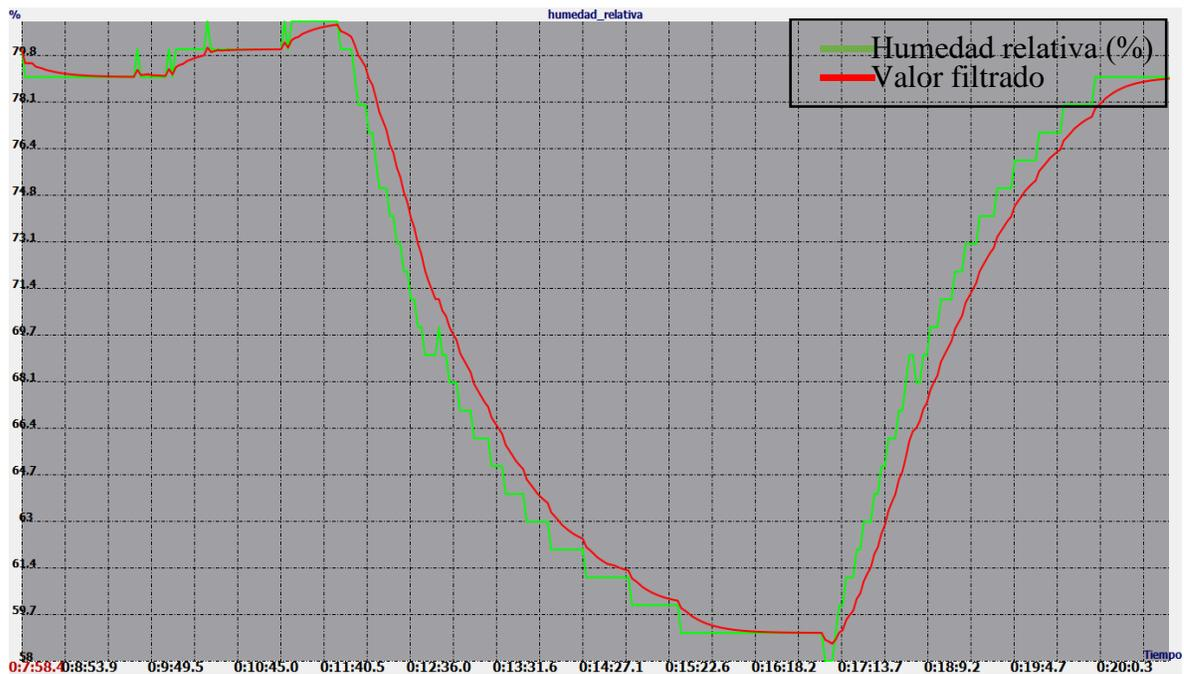
Figura 3.5. Detección de un cambio en la humedad relativa del aire.
