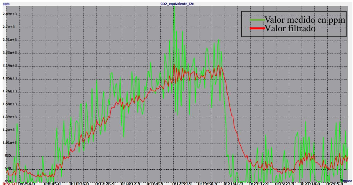
Figura 3.8 Detección del incremento de la concentración de dióxido de carbono en el tiempo.
