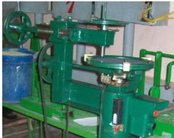
Fig. 6. Máquina utilizada para la realización del ensayo espiga en disco.
