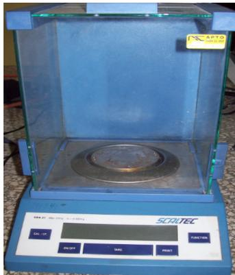
Fig. 4. Balanza marca SCALTEC con precisión de 0.0001g.
