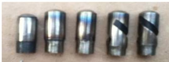
Fig. 1. Puntas de inyector utilizadas como espiga en el ensayo.
