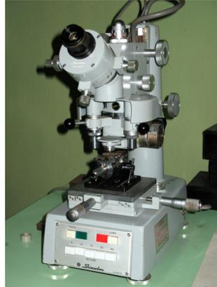
Fig. 3. Durómetro vickers utilizado para medir la microdureza.
