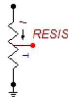
**Figura 2.5.** Representación de la resistencia de puesta a tierra en el ATPDRAW.
