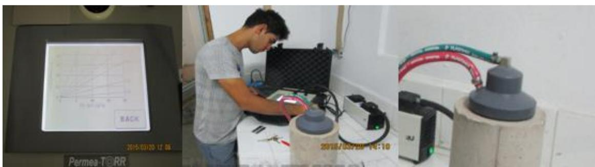
Figura 2.8 Pantalla del Permea-TORR, evaluación de la permeabilidad al aire de probeta y anillos blandos para crear el flujo de izquierda a derecha.
