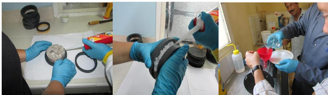
Figura 2.6 Procedimiento experimental para la realización del ensayo de migración de iones.
