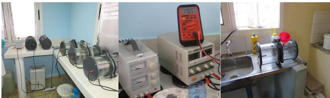
Figura 2.5 Equipamiento para el ensayo de migración de cloruro.
