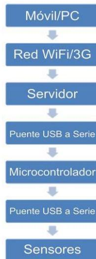
Figura 1.2. Esquema de arquitectura de hardware (Chawla et al., 2016).
