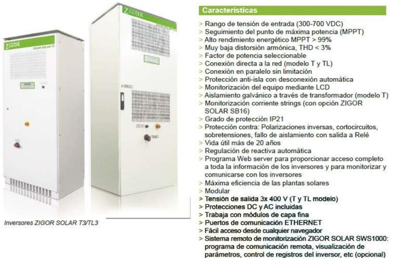
**Figura 2.2: Características técnicas inversor híbrido ZIGOR SOLAR.[12]**
