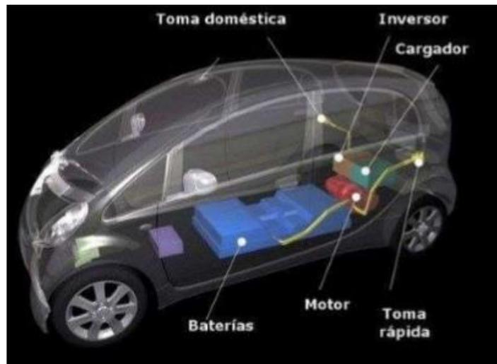
Figura 1.4: Partes de un vehículo eléctrico.
