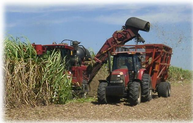
Figura 2.1 Equipos participantes en la cosecha (cosechadora CASE IH 8 000 y el Autobasculante tirado por el Tractor Maxxum Case IH 150).
