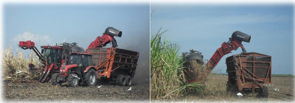
Figura 1.5 Sistema de máquinas para la cosecha mecanizada.
