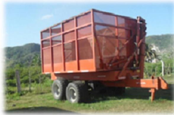
Figura 1.8 Semirremolque autobasculante fabricado en Cuba.
