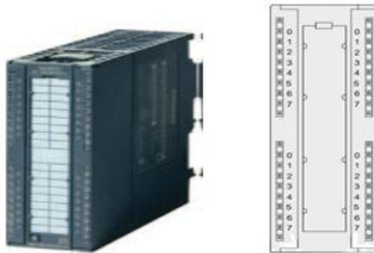
Figura 1. Módulo SM 321 DI 32xDC24V.
