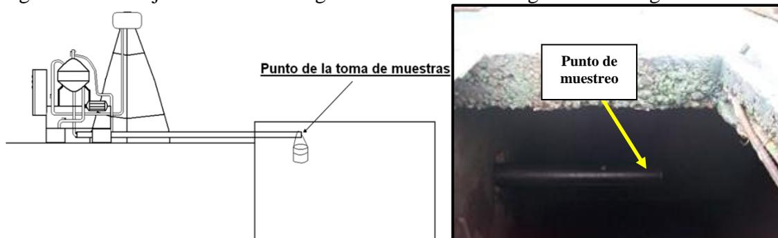
**Fig. 2.2.** Punto de muestreo para CE que operan con diésel.
