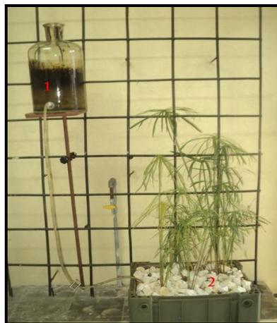
**Fig. 4.17. Estación experimental utilizada, compuesta por tanque estabilizador (1) y humedal de flujo subsuperficial horizontal (2).**
