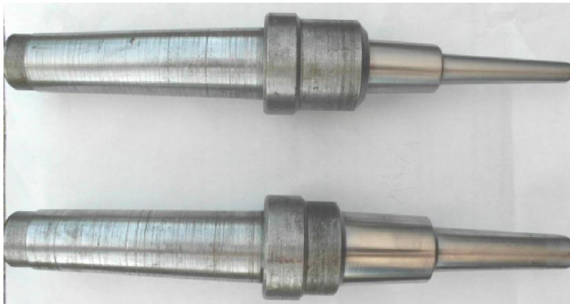
Figura 3.2: Herramienta de conformación utilizadas en los experimentos.
