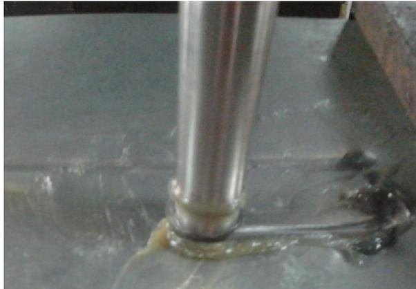
Figura 3.1: Herramienta de conformación realizando una pasada.
