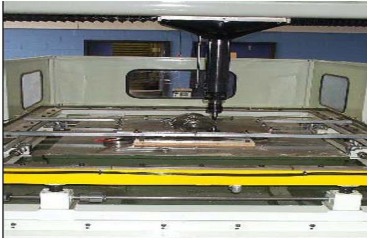
Figura 1.7: Máquina especialmente construida para EIPS. [1]
