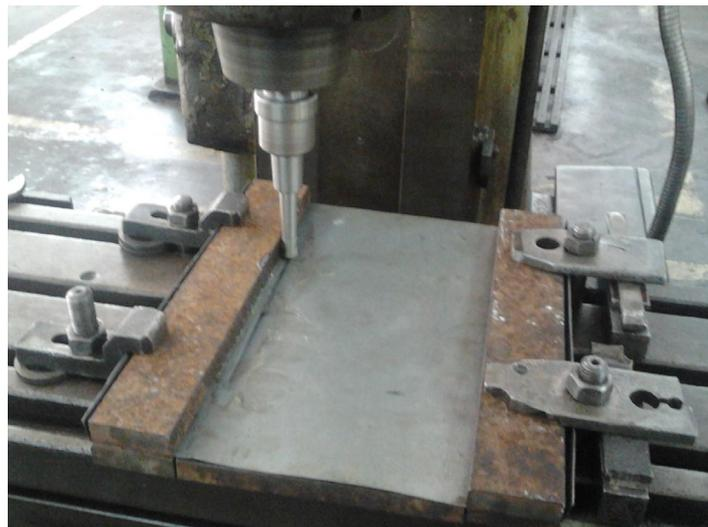
Figura 3.3: Esquema de fijación de la chapa utilizado.
