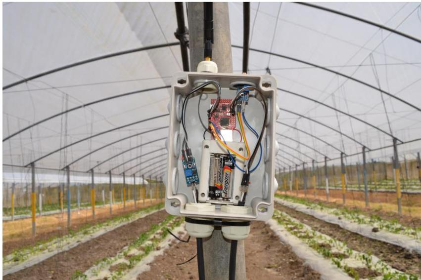
Figura 3.2 Nodo de medición en funcionamiento en una de las casas de cultivos.
