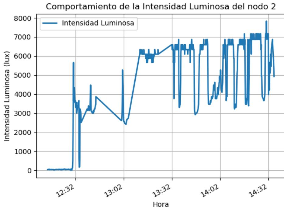
Figura 3.7 Valores de la intensidad luminosa del nodo 2
