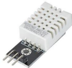
Figura 2.1 Sensor de temperatura y humedad relativa DHT22.
