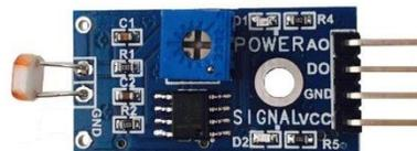
Figura 2.3 Módulo de sensor fotosensible digital y analógico.
