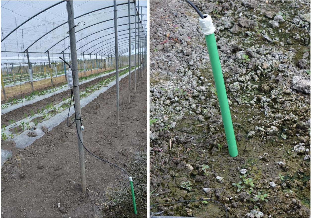
Figura A.20 Nodo de medición en la casa de cultivo.
