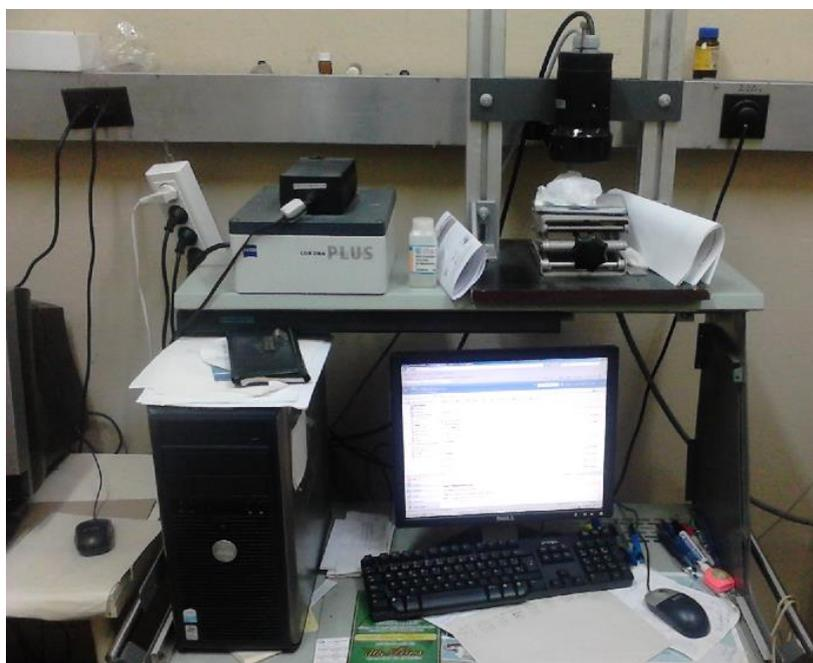
**Figura 3.** Espectrofotómetro de red de diodos conectado a la PC.
