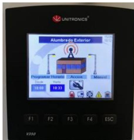
*Figura 26 Pantalla del Alumbrado Exterior donde se muestran las luces activas.*
