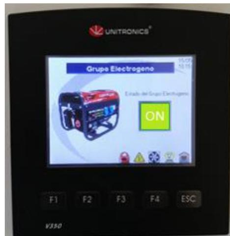
*Figura 41 Pantalla de estado encendido del grupo electrógeno.*
