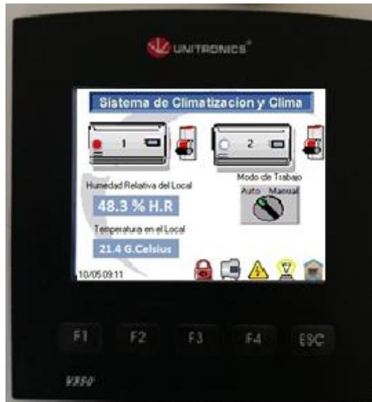
*Figura 31 Pantalla del Clima con el modo Automático activado.*
