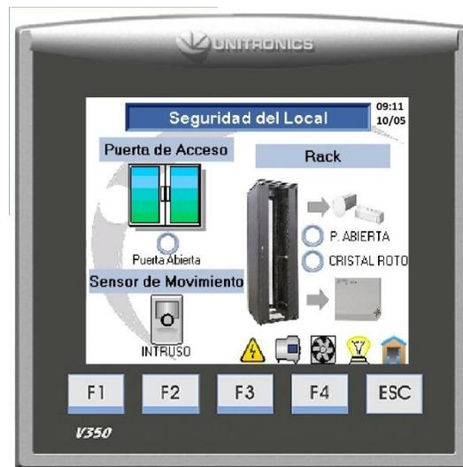
*Figura 19 Pantalla destinada a las alarmas visuales de la seguridad del local.*
