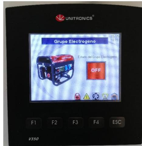
*Figura 42 Pantalla de estado apagado del grupo electrógeno.*
