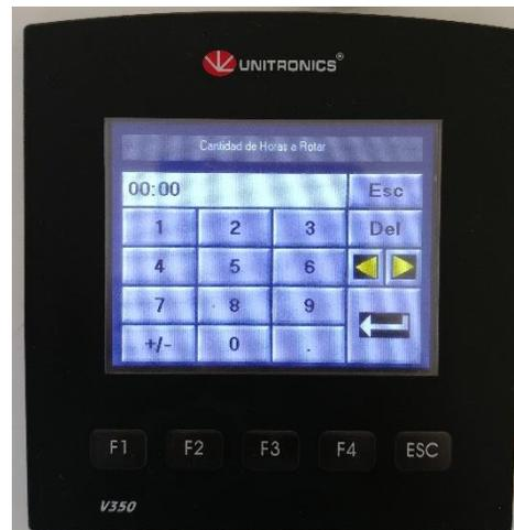
*Figura 27 Pantalla para ingresar el intervalo de horas en el modo Por Horas.*
