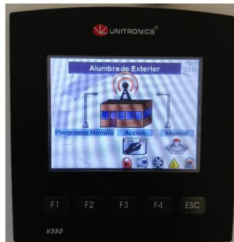
*Figura 28 Pantalla del Alumbrado exterior donde está activado el modo manual y las luces apagadas.*
