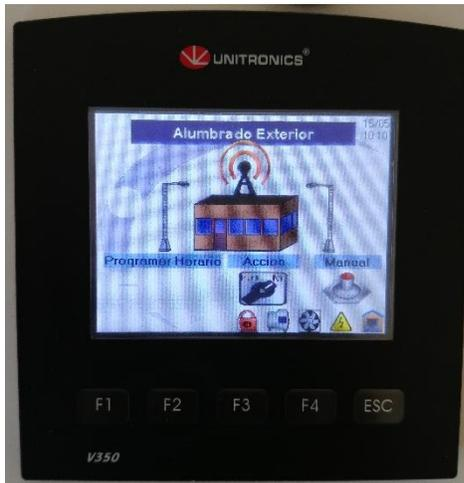
*Figura 63 Pantalla del Alumbrado exterior donde está activado el modo manual y las luces apagadas.*
