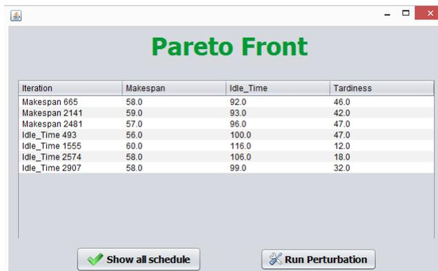
Figura 2-6: Frontera de Pareto obtenida para la instancia ft06, para los objetivos, Makespan, Tardanza e Inactividad.
