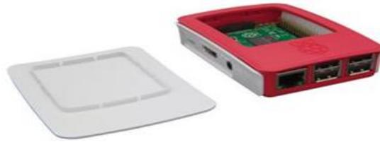
Figura 3.6 Raspberry Pi 3 con su encapsulado.
