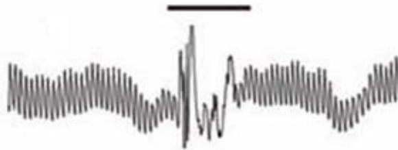
**Figura 1. 7: Movimiento brusco o tirón del cable del dispositivo FPG.**
