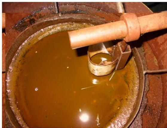
Figura 26. Porta muestra y superficie de ensayo.
