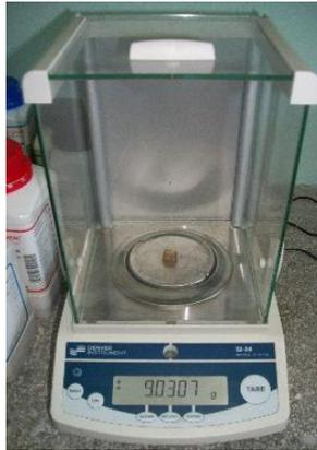
Figura 22. Balanza analítica de precisión Sartorius.
