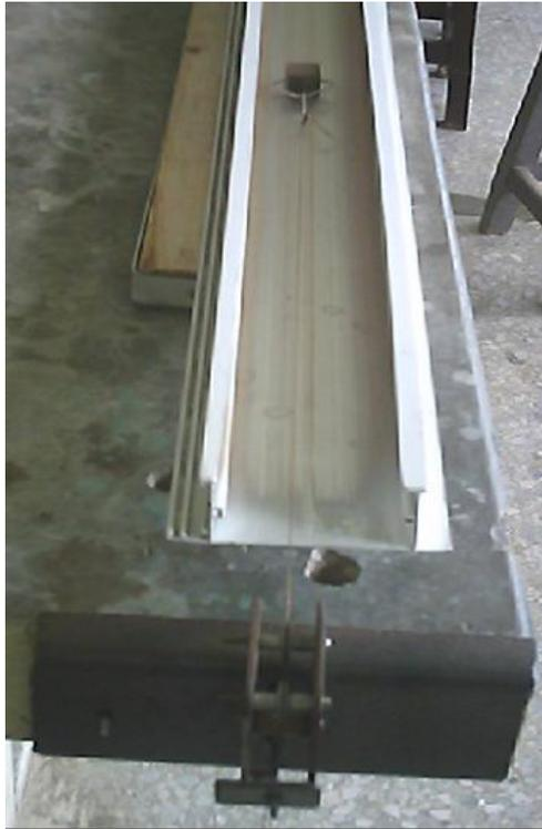
Figura 20. Dispositivo para la determinación de Coeficiente de Fricción (Método de plano horizontal).
