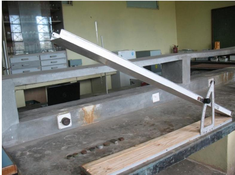
Figura 19. Dispositivo para la determinación del Coeficiente de Fricción (Método del plano inclinado).
