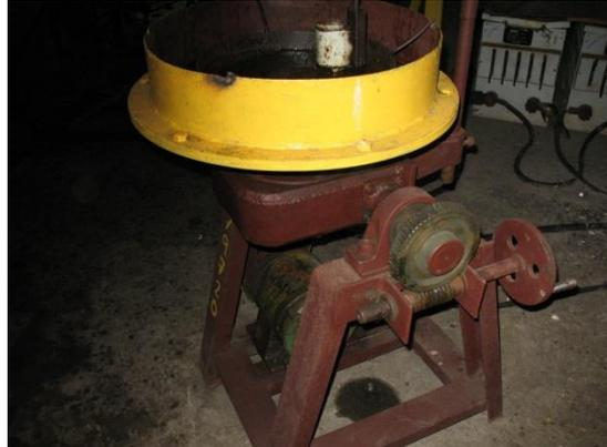
Figura 25. Montaje del ensayo del desgaste abrasivo
